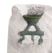
Цвет оксида после распаковки обычных никель-хромовых сплавов
