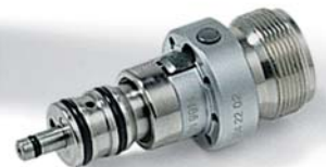
Aquilon Воздушный стерилизуемый микромотор без подсветки, с внешним или внутренним подводом охлаждающей среды. Направление вращения по выбору и регулировка скорости вращения. Диапазон скорости вращения: 5000 – 20.000 об/мин. Вращающийся быстросменяемый переходник для 3-х или 4-канальных соединений.
