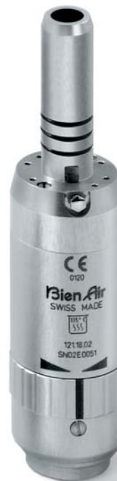
Aquilon Воздушный стерилизуемый микромотор без подсветки, с внешним или внутренним подводом охлаждающей среды. Направление вращения по выбору и регулировка скорости вращения. Диапазон скорости вращения: 5000 – 20.000 об/мин. Вращающийся быстросменяемый переходник для 3-х или 4-канальных соединений.
