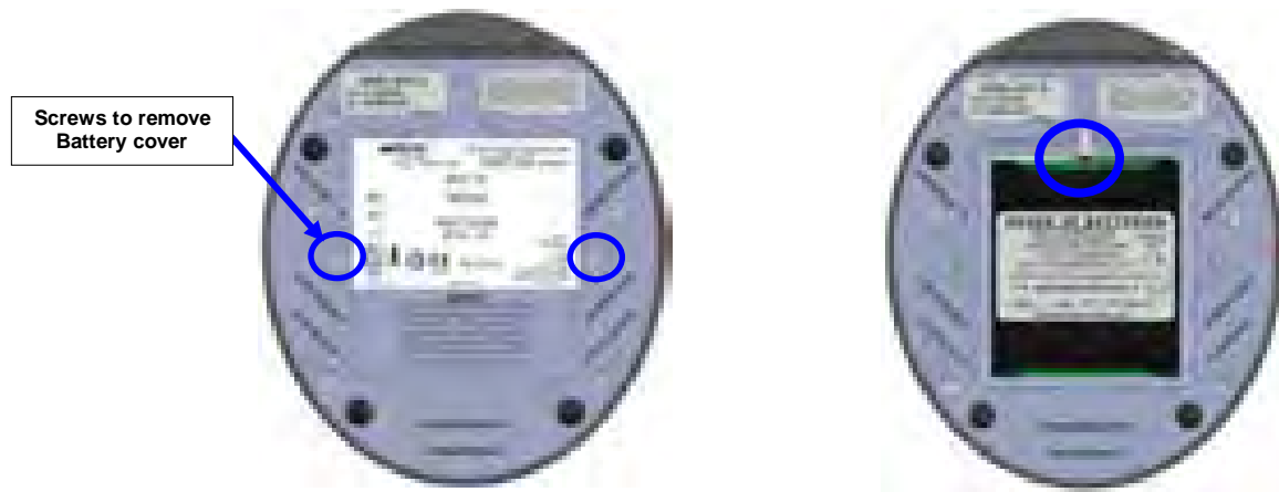
Рис. 8.1: Крышка батареи/основание пульта управления
