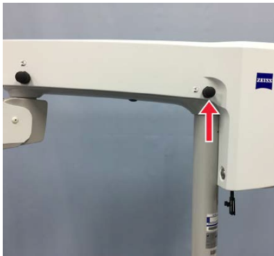
Тормоз оси 1 для фиксации держателя
