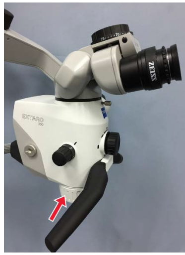
Вариоскоп Varioskop 230 для регулировки фокуса
