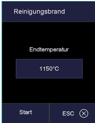
Fig. 5-32 Setup > Reinigungsbrand
