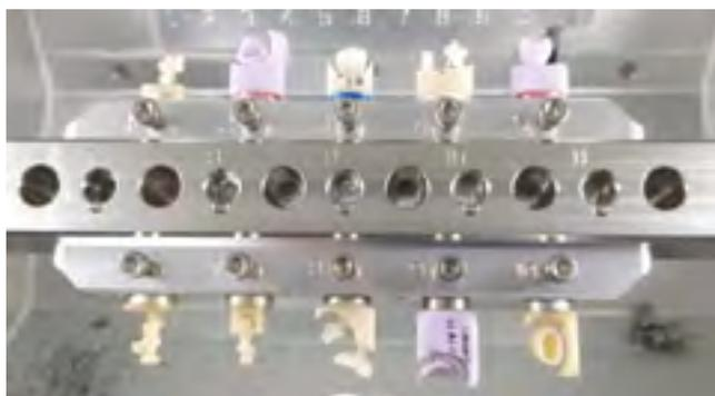
Одновременное фрезерование 10 элементов
