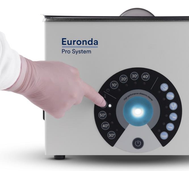
Два рабочих режима позволяют выбрать между 6 предустановленными циклами (инструменты, боры, слепочные ложки, удаление цемента, удаление гипса, протезы), и свободными циклами, с возможностью установить температуру от 30°С до 60°С и время работы от 10 до 40 минут. 6 запрограммированных циклов предполагают 4 фазы работы: Degas, Boost, Normal, Sweep. Eurosonic® 4D оснащена задним сливом с краном и трубкой, а также боковыми ручками, которые обеспечивают возможность удобного переноса машины.
