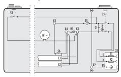
С1 Помехоподавляющий конденсатор E1/E2 Нагреватель 2 x 250–300 Вт F1/F2 Предохранитель
