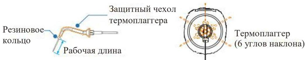
В зависимости от типа зубов, подлежащих лечению, выберите подходящий термоплаггер, установите его в насадку Meta Pack и отрегулируйте нужный угол наклона. Прочно соедините их. Имеются следующие модели (коды) термоплаггеров F, FM, M, ML и L (L предназначен для дополнительного использования)
