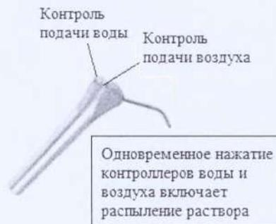
Внутренний корпус шланга вода/воздух уже подключен к устройству. Наденьте внешний кожух, стараясь не нажимать элементы управления 1 и 2, и медленно поворачивайте его, пока оно не защелкнется.
