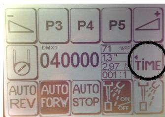
рис.5 Дисплей с функцией [Symbol] для регулировки скорости перистальтического насоса
