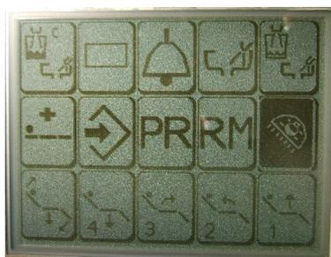
На рисунке изображено стартовое меню, которое появляется на дисплее при включении установки. Инструменты находятся в режиме ожидания, светильник включен.
