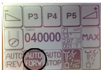
**Функции микромотора с функцией "AUTO FORW" :** при отведении педали вправо , микромотор вращается по часовой стрелке, он останавливается, когда достигает/ превышает установленное значение крутящего момента, меняет вращение (вращается против часовой стрелки ) в течение времени, заданном на дисплее и далее продолжает вращаться по часовой стрелке.
