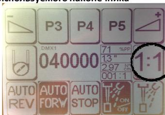
Рис.3 Дисплей с функцией "TORQUE" для регулировки торка в N (Ньютон)/см.
