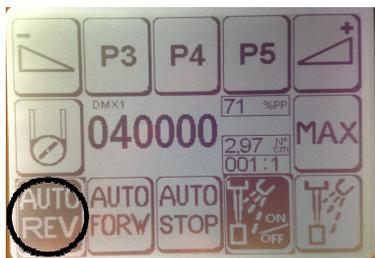
**Функции микромотора с функцией "AUTO REV"** : при отведении педали вправо , микромотор вращается по часовой стрелке, он останавливается, когда достигает/превышает установленное значение крутящего момента, меняет вращение против часовой стрелки и останавливается только при освобождении педали.
