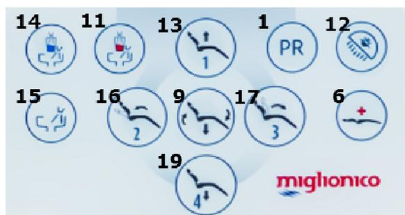
**ВНИМАНИЕ:** Если нужно остановить кресло во время автоматического движения, следует нажать одну из 4-х кнопок (13-16-17-19) или педаль экстренной помощи, указанную в разделе «Безопасность».
