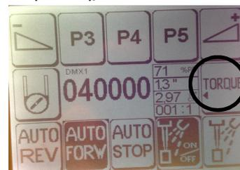
рис.4 Дисплей с функцией "TIME" для регулировки времени реверса.
