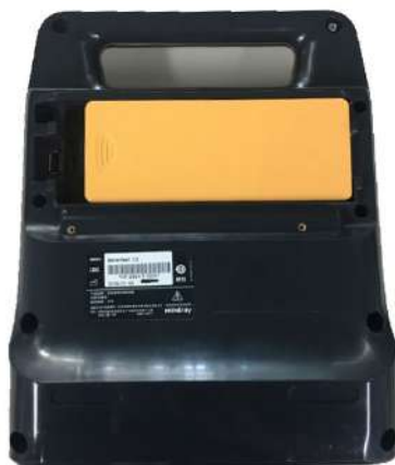
Вид сзади (со снятой крышкой для батарейного отсека и установленной батареей)
