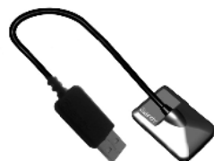
Датчик Opteo: размер 1 или размер 2 (кабель длиной 3 м / 9.9 футов)
