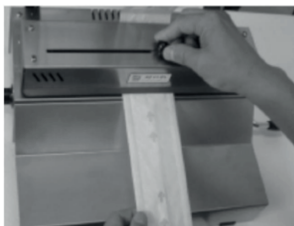
Рисунок 7. схема обрезания пакета для запаковывания инструмента
