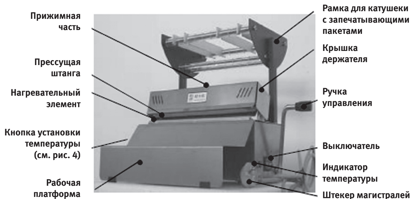
Рисунок 1. Схема структуры аппарата для запечатывания инструментов
