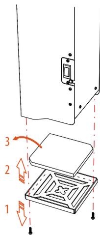
Снятие воздушного фильтра
