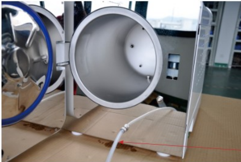
Слив резервуара для воды
