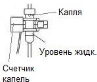
Рисунок 11. Схема установки счетчика капель
