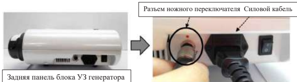
Рис. 14 Подключение сетевого шнура и ножного переключателя к блоку УЗ генератора
