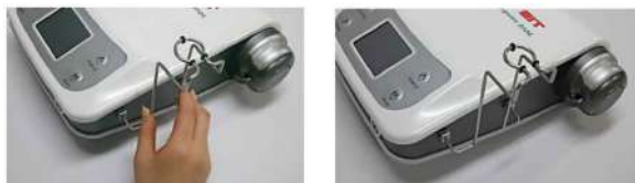
Рис. 16 Установка держателя наконечника на блоке УЗ генератора
