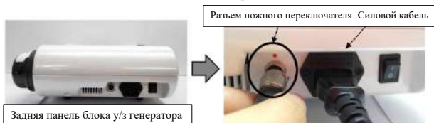
Рис. 14 Подключение сетевого шнура и ножного переключателя к блоку УЗ генератора
