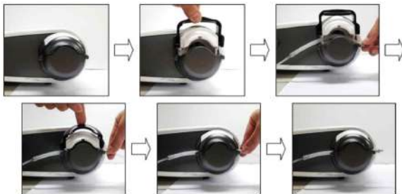
Рис. 20 Размещение шланга в перистальтическом насосе
