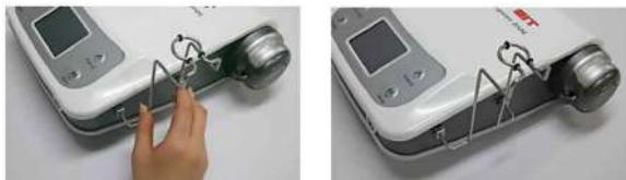
Рис. 16 Установка держателя наконечника на блоке УЗ генератора
