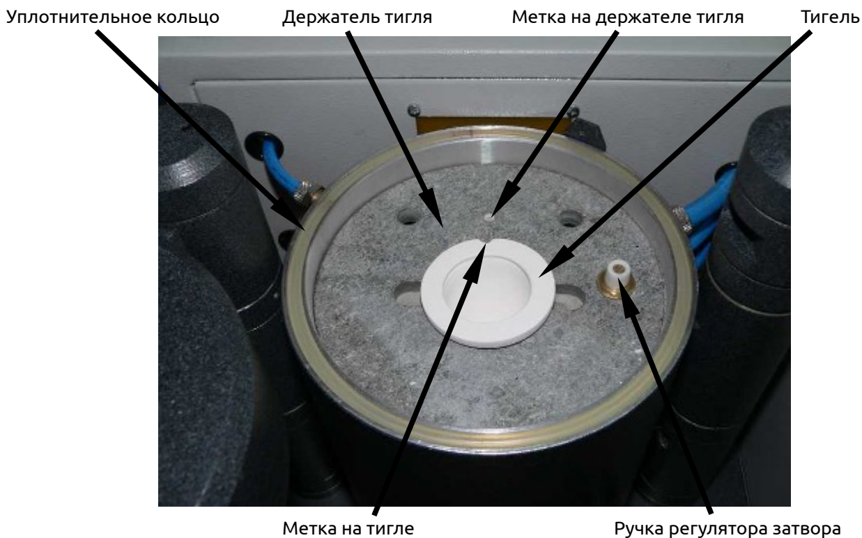
8.6 Рисунок 5. Размещение тигля в камере индуктора.
