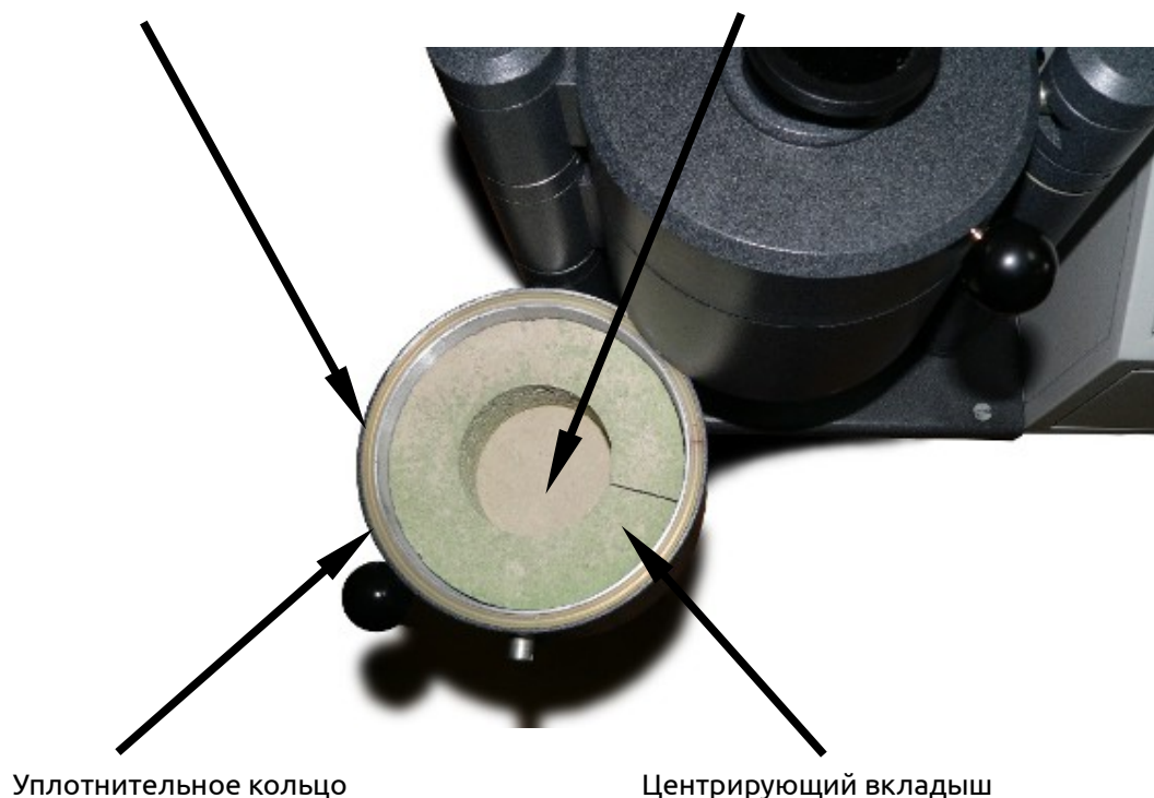
Рисунок 3. Камера опоки (в открытом состоянии).
