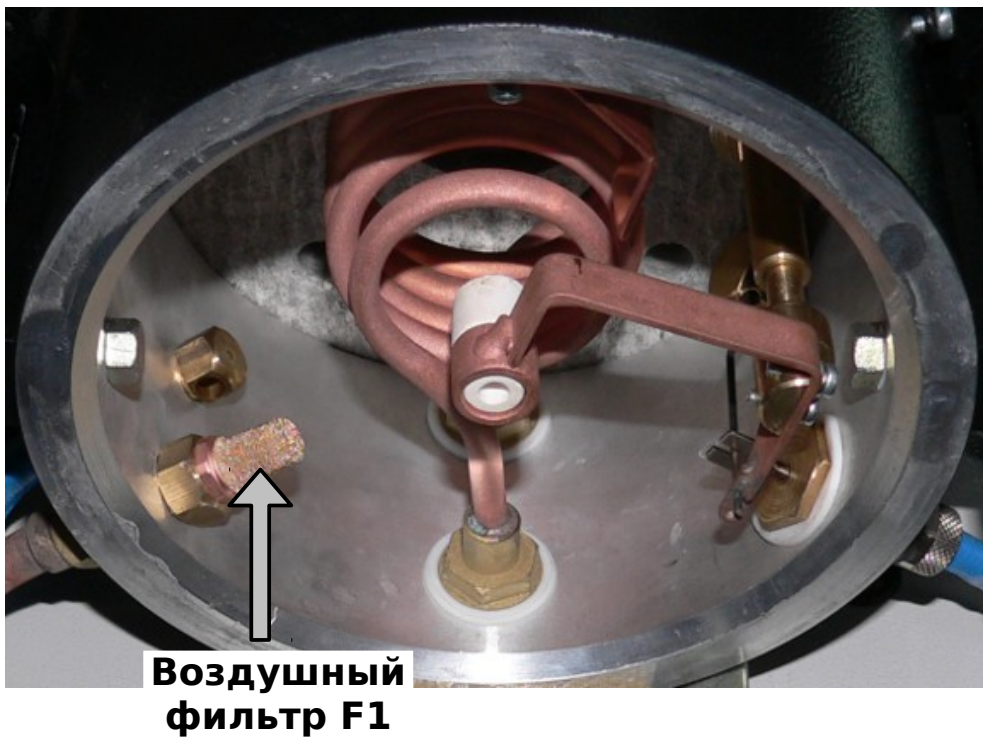
Рисунок 6. Размещение воздушного фильтра F1 в камере индуктора.
