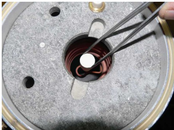
Рисунок 4. Установка керамической вставки в затвор.
