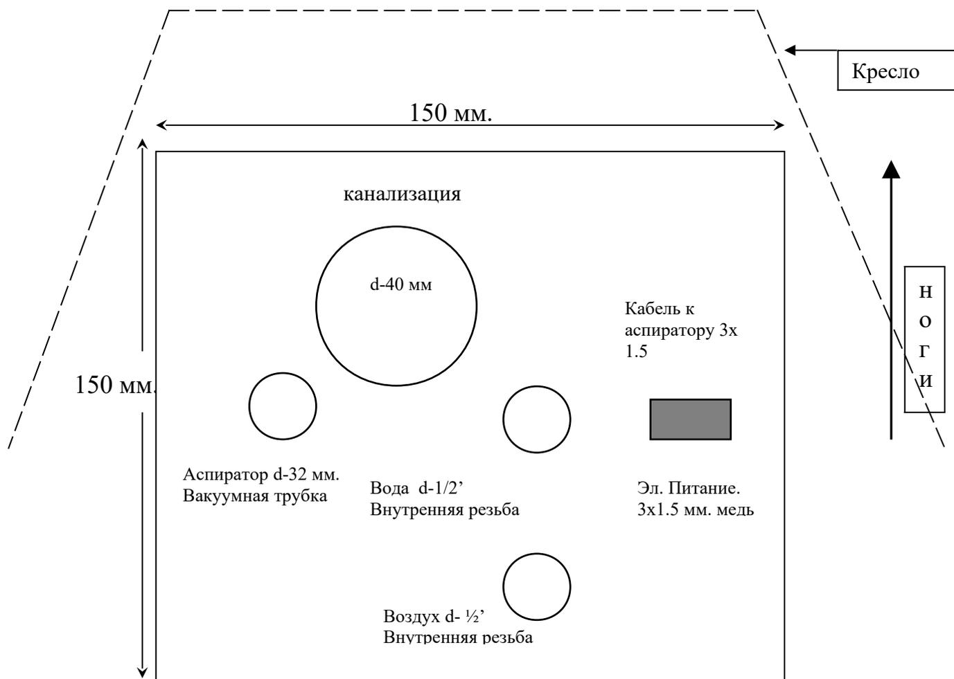
Подводки воды и воздуха должны выступать из пола на 50-60 мм. шаровый кран, выход 1/2 дюйма внутренняя резьба.
