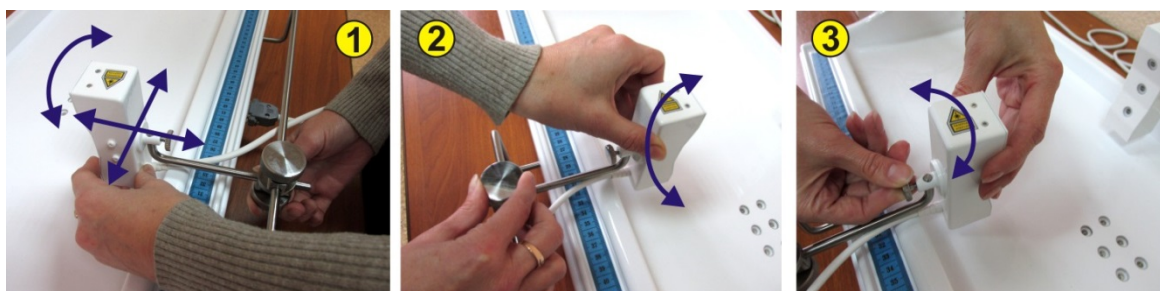
Рис.11. Варианты изменения положения терминалов магнито-лазерного излучателя детское "ОГОЛОВЬЕ" с помощью кронштейнов с фиксаторами.
