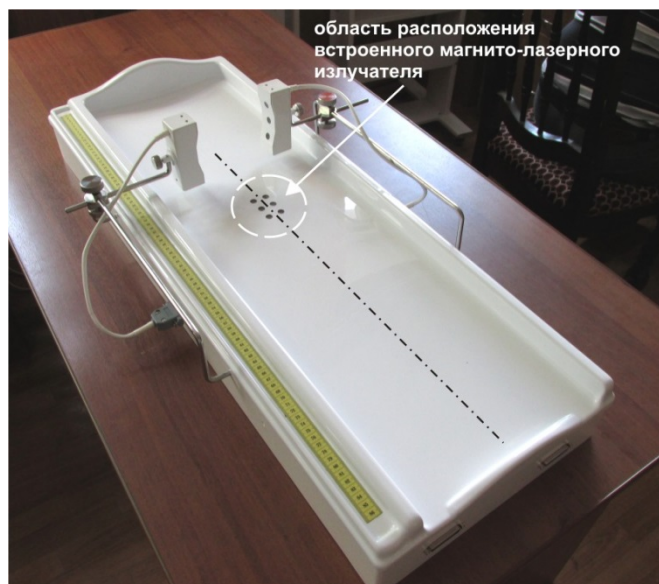
Рис.7. Место расположения встроенного спаренного магнито-лазерного излучателя для лечения перинатальных поражений шейного отдела позвоночника новорожденных под поверхностью ложемента.
