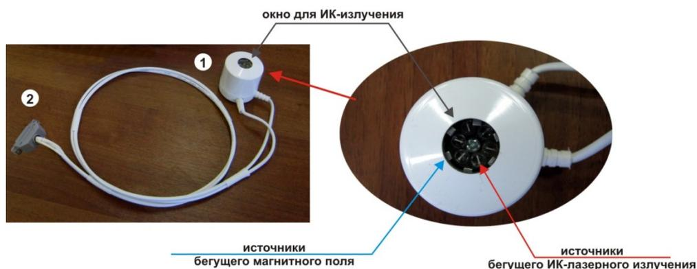
**Рис.7.** Излучатель магнитного поля и ИК-лазерного излучения.
