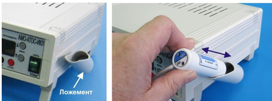
**Рис.5.** Расположение ложемента для датчика магнитного поля и ИК-лазерного излучения и его использование.
