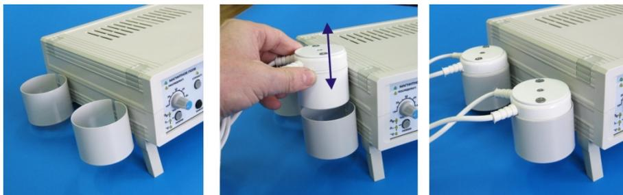
**Рис.4.** Расположение ложементов и установка в них коаксиальных излучателей «бегущего» магнитного поля и «бегущего» ИК-лазерного излучения перед проведением процедуры или после её окончания.
