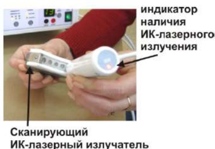
Рис.10. Проверка работы сканирующего ИК-лазерного излучателя.
