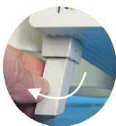
Рис.4. Установка передних ножек корпуса электронного блока в "рабочее" положение.
