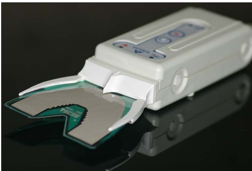
Записывающая ручка T-Scan III подсоединяется напрямую к компьютеру через USB интерфейс
