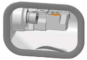
FIG. 59 TOOL MAGAZINE (MARKED ORANGE)
