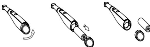
4.3 Когда батарею необходимо зарядить, подключите разъем USB типа A в адаптер, подключите адаптер к сети переменного тока 100~240 В. Затем подключите кабель USB разъемом Micro USB к зарядному устройству. Установите главный блок на точку зарядки, и батарея начнет заряжаться.
