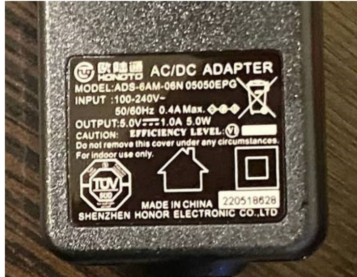
Пример маркировки блока электропитания, модель ADS-6AM-06N 05050EPG
