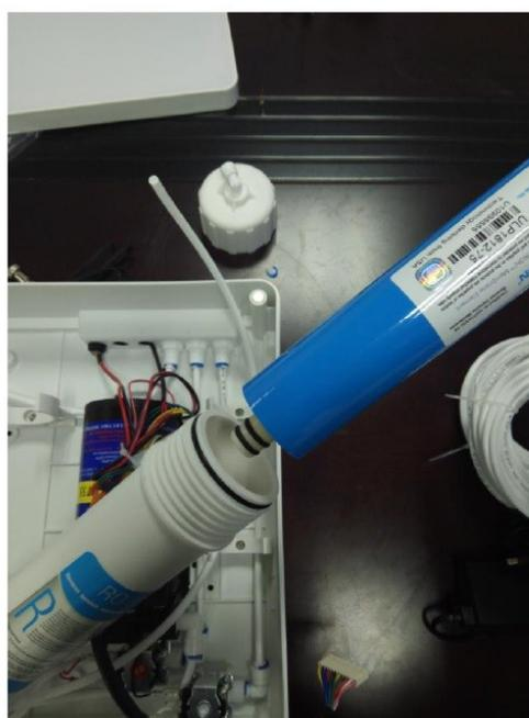
3. Используйте ключ для фильтра, чтобы закрутить и затянуть крышку фильтра по часовой стрелке. Вставьте обратно ПВХ трубку в
