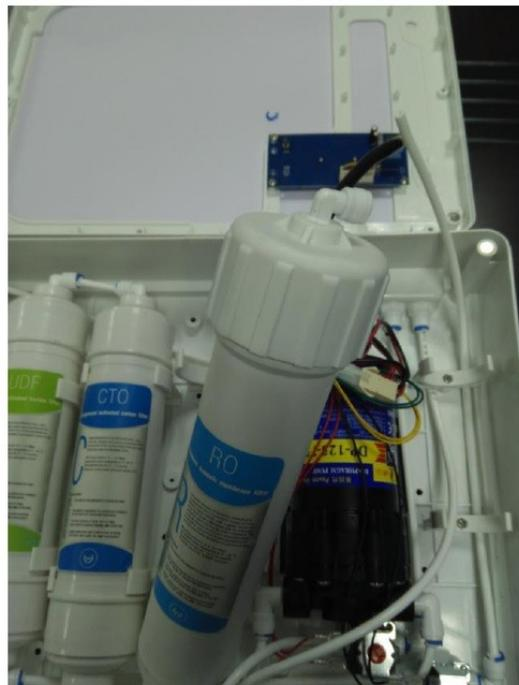
2. Используйте ключ для фильтра, чтобы открутить верхнюю крышку фильтра RO, откручивается против часовой стрелки. Снимите мембрану фильтра обратного осмоса, O-образная часть фильтра должна быть направлена лицом вниз в фильтр и закреплена.
