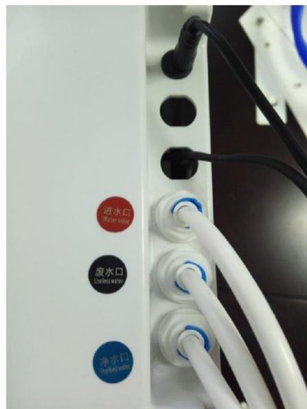
7. В соответствии с расстоянием отрежьте нужное количество трубки, чтобы присоединить один конец к порту отработанной воды, отмеченный черным, а другой конец присоединить к коммуникациям, чтобы удалять отработанную воду, которая появляется во время
