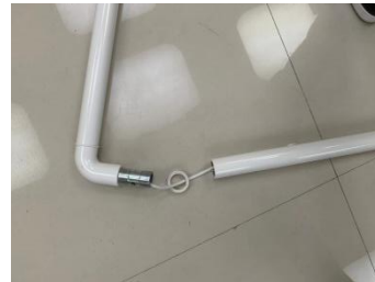
Сборка штанги светильника
